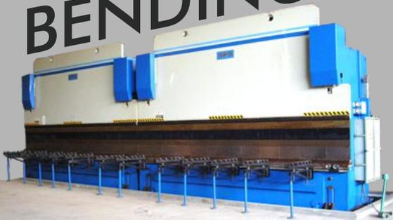
**Bending** adalah proses tekuk lembaran pelat yang menghasilkan bentuk V, bentuk U, atau bentuk yang lain sepanjang sumbu lurus pada bahan.
